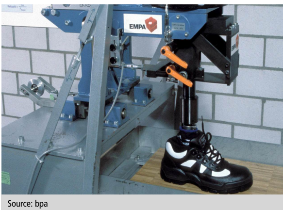
Illustration 1 Dispositif d'essai pour sols et chaussures BST 2000, Empa (St-Gall)
