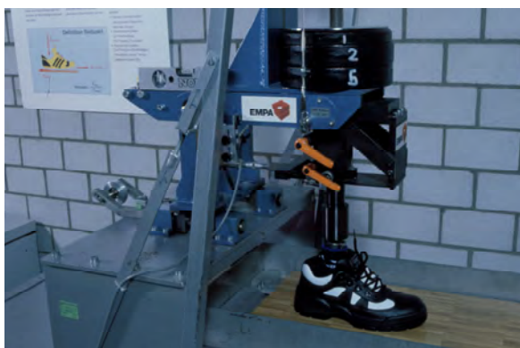
Illustration 4 Dispositif d'essai pour sols et chaussures BST 2000, Empa (St-Gall)
